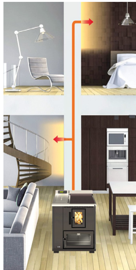
Canalizzazione aria calda
